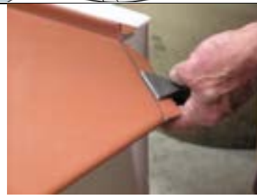
3) Gör omvik: för att få ett öppet omvik kan fliken justeras med plastklubba med ett ca 2mm inlägg i öppningen (håll till på ett arbetsbord, med skyddsunderlägg, se nästa bild)
